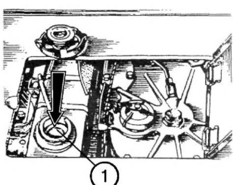
Снимите пробку радиатора и проверьте уровень охлаждающей жидкости, который должен быть на 50-60 мм ниже верхнего торца заливной горловины (1). Если необходимо, долейте жидкость до уровня.
