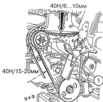
Для проверки натяжения ремня генератора дизеля с удлиненным щитком приложите усилие около 40 Н на середине ветви «шкив генератора - шкив водяного насоса» (1). Прогиб должен быть в пределах 6... 10 мм. Если необходимо, натяжение ремня регулируйте поворотом корпуса генератора, предварительно ослабив и затем затянув болт крепления планки и гайки болтов крепления генератора.
