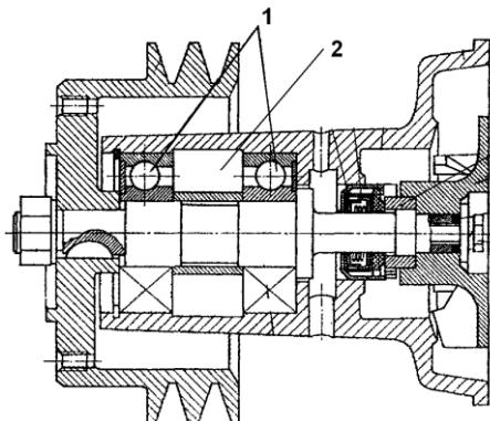
В подшипники 1 и полость 2 насоса закладывается одноразовая смазка "Литол-24", и в течение всего периода эксплуатации смазка подшипников не требуется.
