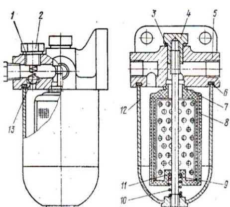
***Рис.4.2. Масляный фильтр турбокомпрессора.***
