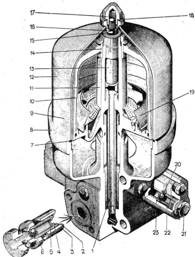
очистить внутренние полости крышки от отложений деревянным скребком и промыть все детали ротора в дизельном топливе. Прочистить отверстия форсунок медной или латунной проволокой диаметром 2 мм;
